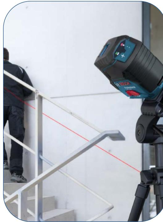
Работа в режиме наклона с LED индикацией – для установки труб/поручней/лестниц
