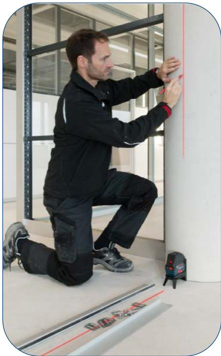
Вертикальное нивелирование с удлиненной проекцией лазерной линии (почти 360°), например, для установки гипсокартонных перегородок
