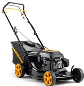
Модель имеет привод на задние колёса, более мощный двигатель (2.3 кВт при 2600 об/мин), более широкую режущую деку 51 см, и травосборник с большим объёмом (55л), что обеспечивает её более эффективное использование на приусадебных участках среднего размера, в режиме «сбор в травосборник + выброс скошенной травы назад»
