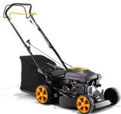
Модель конструктивно во многом похожая на модификацию M40-110 Classic, но имеет более широкую дека 46 см, эргономичные рукоятки, колеса большего диаметра и привод на задние колёса (4 км/ч), что позволяет значительно облегчить кошение и утомляемость оператора при обработке участков малой и средней площади.
